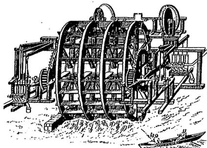
Pumpwerk mit Wasserradantrieb.
