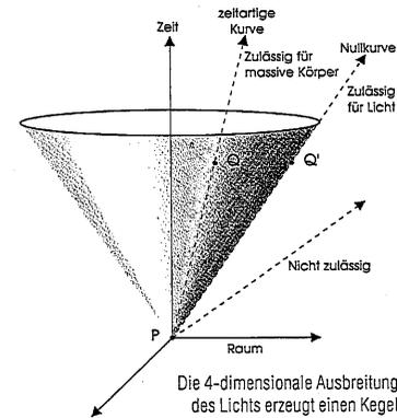
Vom Punkt P können nur Punkte Q und Q' innerhalb oder auf dem Lichtkegel durch Signale erreicht werden.
